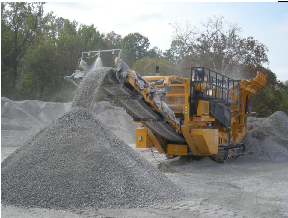
Предвидената за експлоатация роторна трошачка в действие с покрита транспортна лента и водно обезпрашаване на преработената скална маса.
